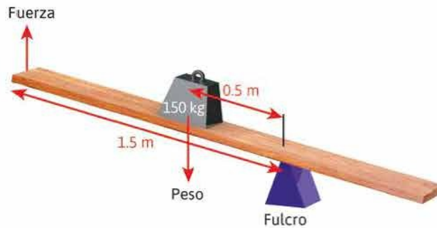
Figura 9.7 Esquema de las fuerzas implicadas en una palanca cuando el peso está del mismo lado que la fuerza aplicada.
