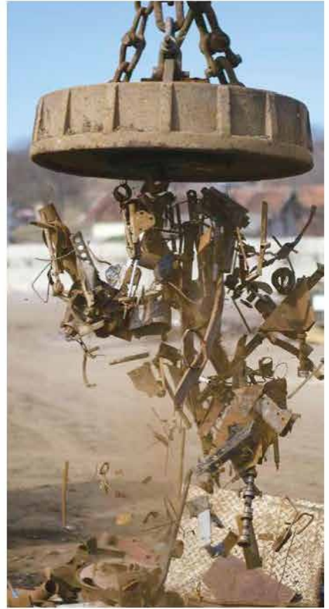
Figura 29.3. Electroimán usado para levantar chatarra.
