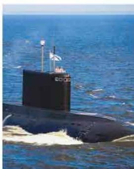
Figura 10.3 Los submarinos se sumergen o emergen llenando o vaciando de agua una cámara especial.
