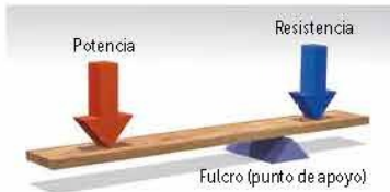
Figura 9.5 Diagrama de una palanca. En esta se puede observar el punto de apoyo (o fulcro), la fuerza de resistencia y la potencia (que es la fuerza que aplicamos).
