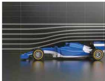
Figura 8.7 Un vehículo de carreras es probado en un túnel de viento para comprobar que el aire fluye por su perfil de manera laminar, sin vórtices. Estos, si se produjeran, generarían intensas fuerzas de fricción.
