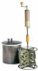
Figura 20.3 Al hacer girar unas paletas sumergidas en agua, Joule observó que la temperatura de esta aumentaba.
