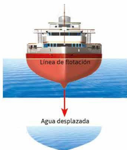
Figura 10.2 El peso del agua que desplaza al casco de un barco es igual al peso del barco.
