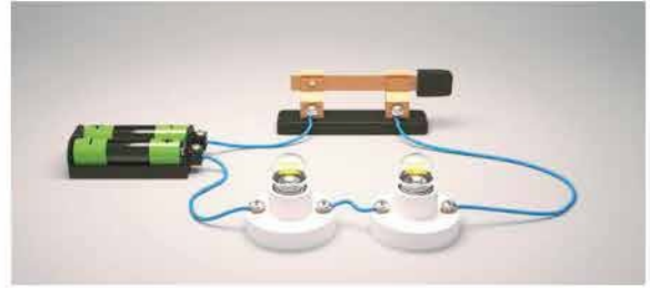
Figura 27.2 Las baterías son una especie de bomba de cargas eléctricas. Cuando estas atraviesan el filamento del foco, este resplandece por la alta temperatura que alcanza.
