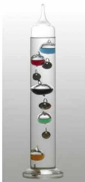
Figura 19.1 El termómetro de Galileo aprovecha cómo cambia la densidad del líquido con respecto a la temperatura, modificando la flotación de las ampollitas.
