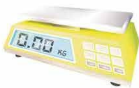
Figura 7.4 Las básculas digitales deben ser calibradas en el sitio en que se utilizan, para obtener la medida de la masa con el nivel de precisión deseado.
