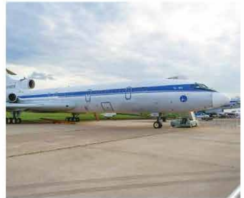
Figura 22.7 Algunos aviones, como el Túpolev Tu-155, ruso, usan como combustible el hidrógeno líquido.
