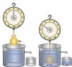
Figura 10.1 Este dispositivo permite medir directamente la cantidad de líquido desalojado al sumergir un objeto y el peso del objeto dentro del líquido.
