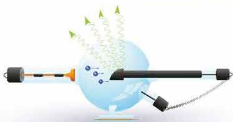
Figura 16.2 El tubo de Crookes contiene un gas a baja presión y tiene electrodos en cada extremo. Cuando estos se conectan a una batería, se forma luz en su interior.
