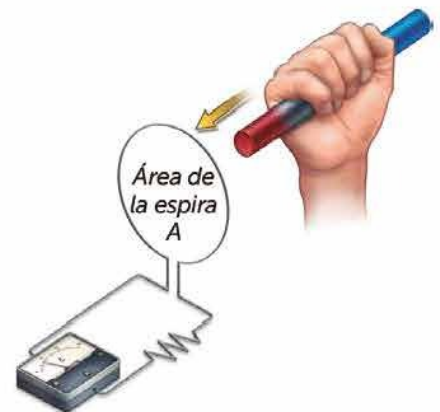
Figura 29.2 La inducción de Faraday se produce por el movimiento del imán de arriba hacia abajo, que genera un campo magnético que cambia con el tiempo y que induce una corriente eléctrica.
