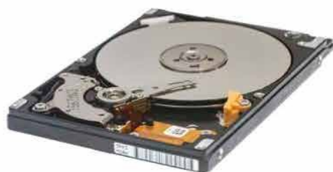
Figura 28.2 Los discos de almacenamiento de las computadoras emplean el magnetismo para guardar la información.
