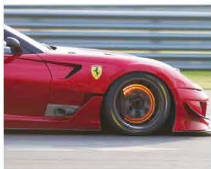
Figura 11.3 En los automóviles, la energía cinética que adquieren durante el frenado se convierte en energía térmica que calienta los discos de freno hasta el rojo vivo.
