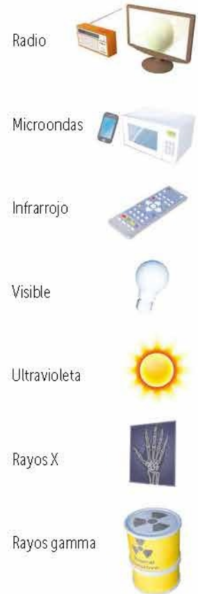
Figura 31.3 El espectro electromagnético y algunas de sus aplicaciones de acuerdo con su frecuencia.
